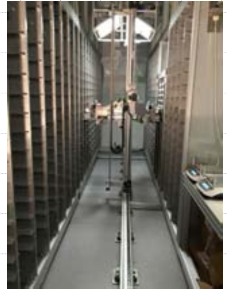
图 2: 机器臂和成像系统在中心,种子托盘存储架在外围,图片右侧是称重站。
